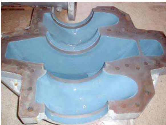
Figure II. 28 : Surface intérieure de la pompe centrifuge réparée
