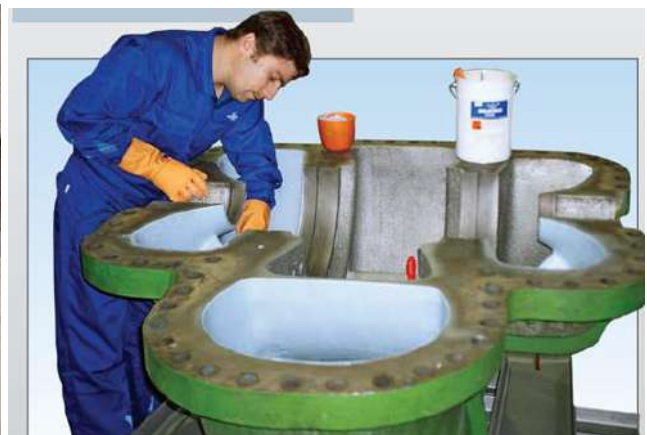
Figure II. 27 : Réparation de la surface de contact intérieure par un opérateur qualifié
