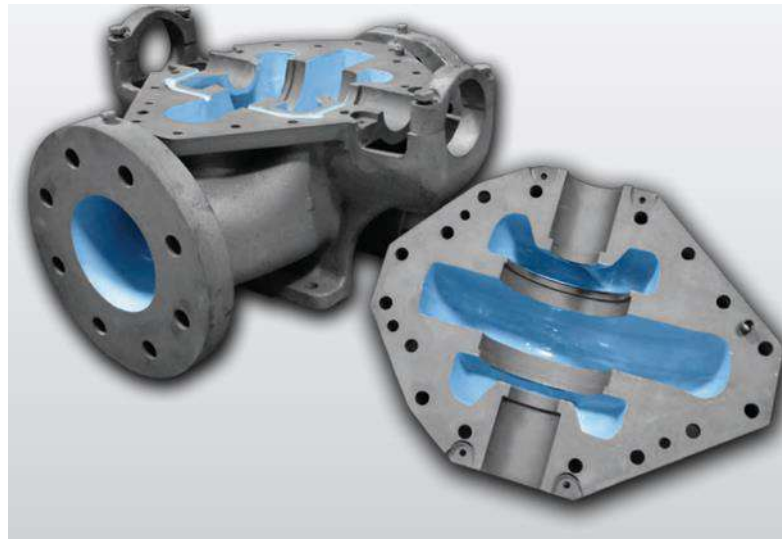
Figure II. 29 : Rénovation et réparation finalisée de la surface de contact d'une pompe centrifuge
