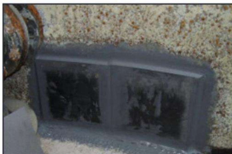
Figure II. 16: Collage par plaques métallique en acier anti-usure à froid [11]
