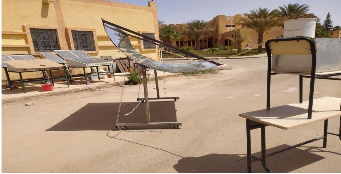
الشكل (V-11): صورة للتركيب التجريبي لدمج المركز الشمسي PTC مع المقطر الشمسي.
