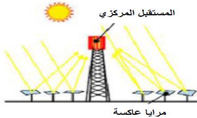
الشكل (II-4): البرج المركزي الشمسي CRC [16].
