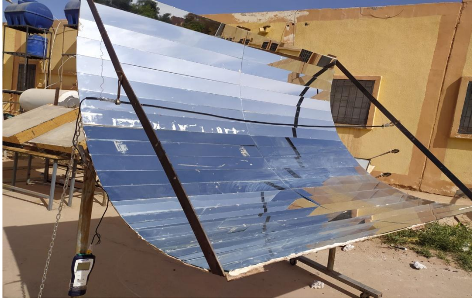
الشكل (V-7): صورة تجريبية للمركز الشمسي PTC.
