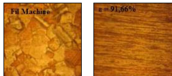
Figure 1: Microstructures du fil machine et fils tréfilés ( \epsilon_3 = 91,66\% )
