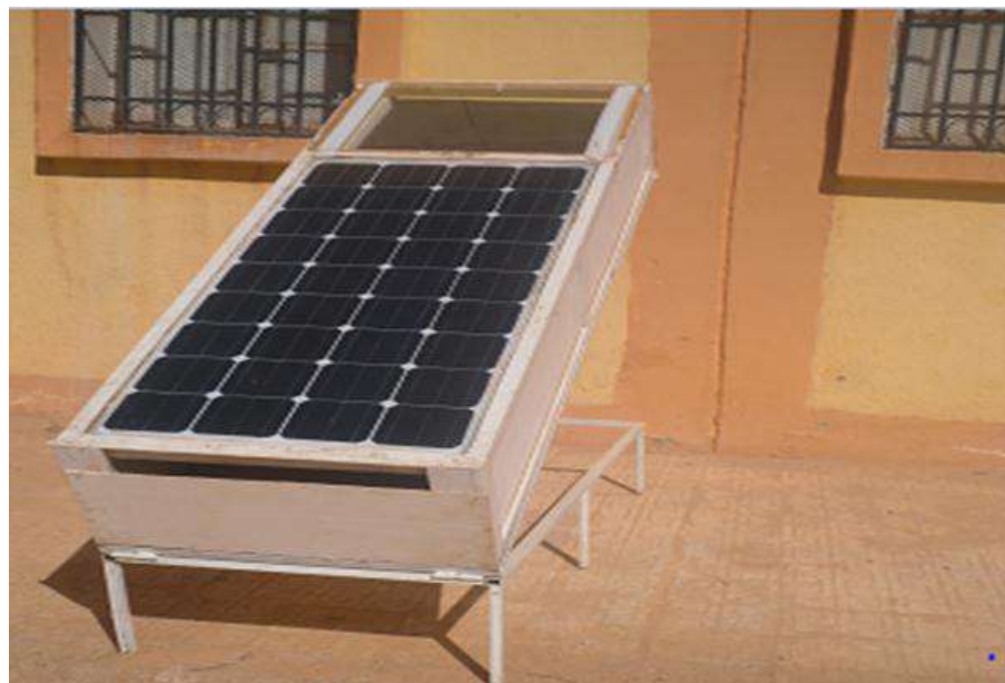
Figure 3.1: Le prototype du système hybride PV / T
