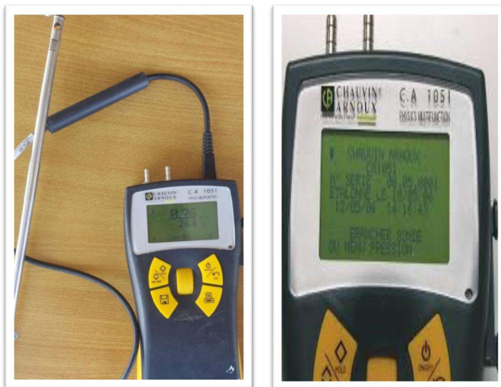
Figure 3.4: L'anémomètre chauvin Arnoux (C.A 1051)
