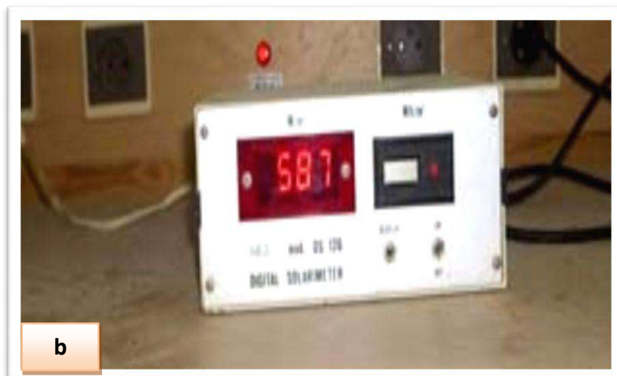
Figure 3.3: Pyranomètre : a) capteur de radiation solaire b) afficheur numérique
