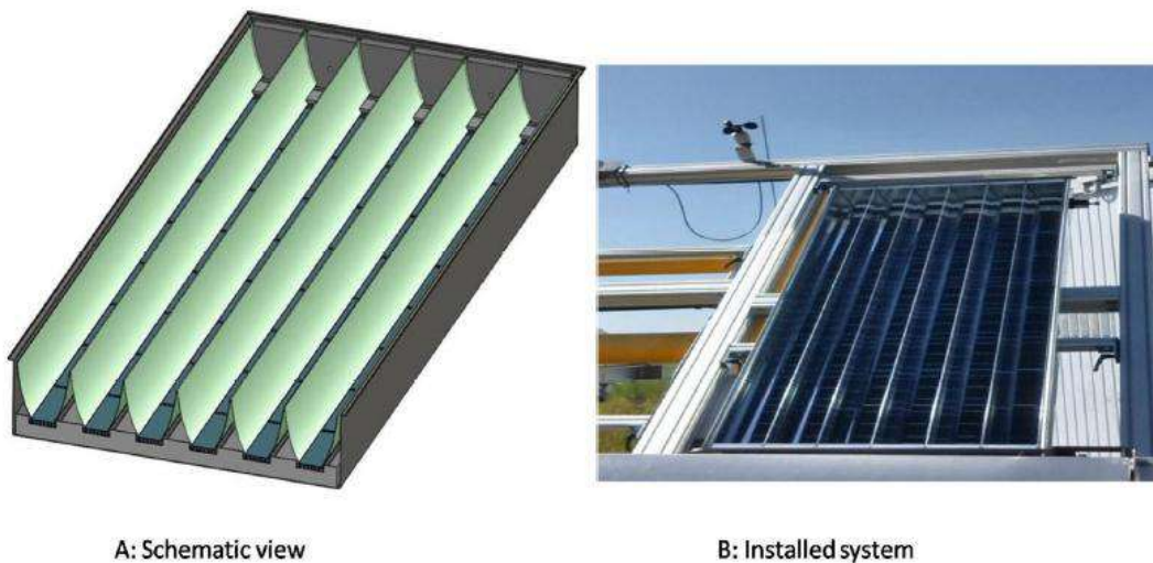
Figure 2.39: CPVT avec concentrateurs paraboliques composés [85].
