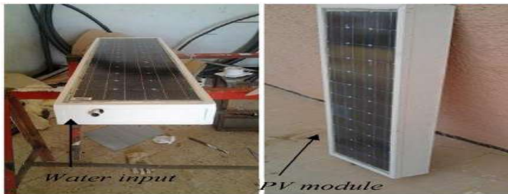
Figure2.22: Le prototype serpentin du collecteur PV/T.
