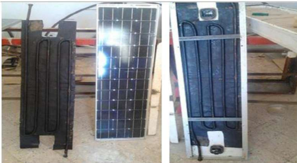
Figure 2.18: Surface absorbante en acier galvanisé pour système PVT [59].
