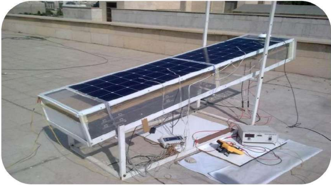
Figure 2.34: Une photographie de l'installation expérimentale d'un collecteur d'air hybride PV / T [80].
