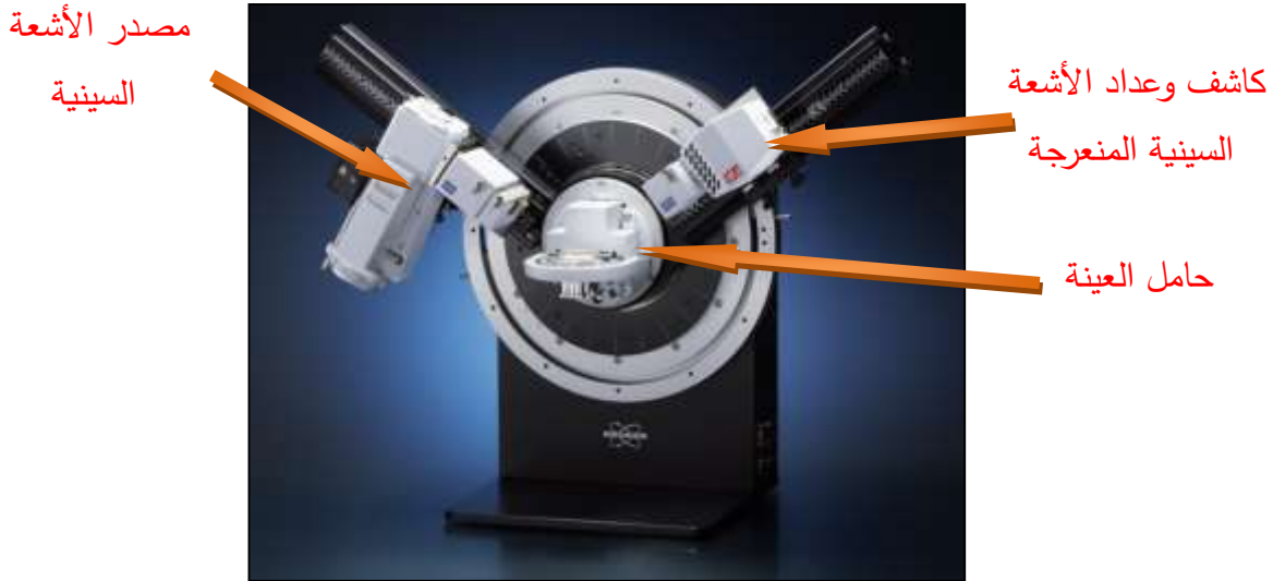
الشكل (3-I) : الجهاز الآلي لحيود الأشعة السينية (D8 ADVANCE ECO).
