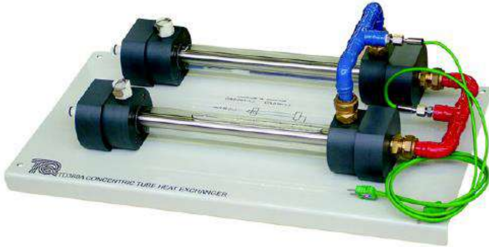
الشكل (1-1): المبدل الحراري الأنبوبي البسيط
