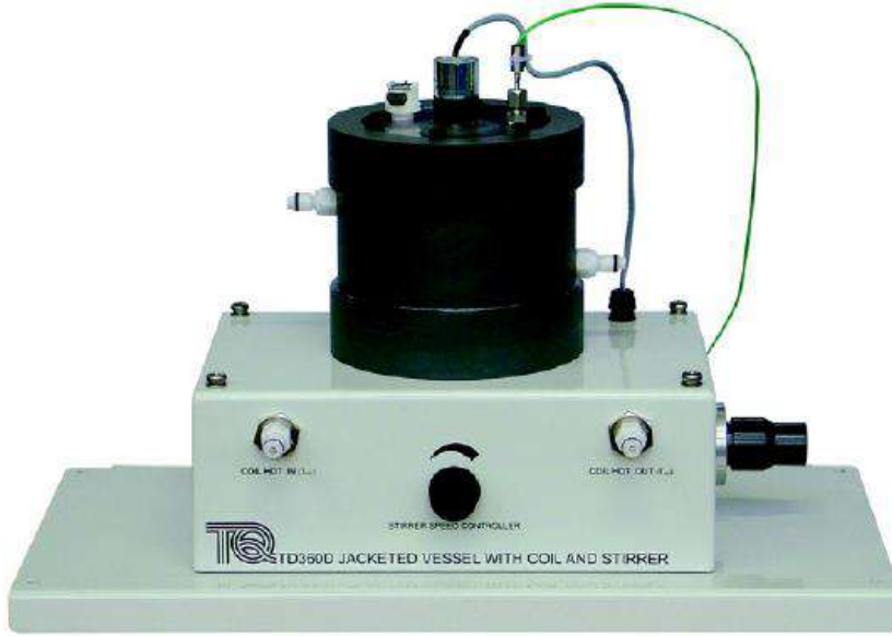
الشكل (1-8): المبدل الحراري بوعاء مغطى مع ملف أو مخفاق
