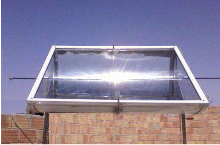
الشكل (3.III): مجمع PTC بوجود غطاء زجاجي مسطح [17]
