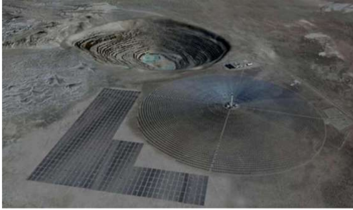
الشكل(II.10):تقديم النظام الهجين PV-CSP المسطح في شمال تشيلي [32]
