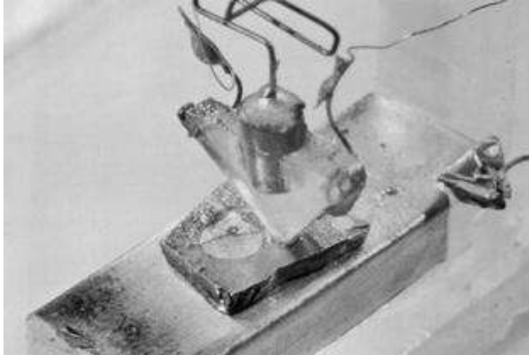
الشكل (14): أول الترانزستور صنع في مختبرات بيل في عام 1948 [2]
