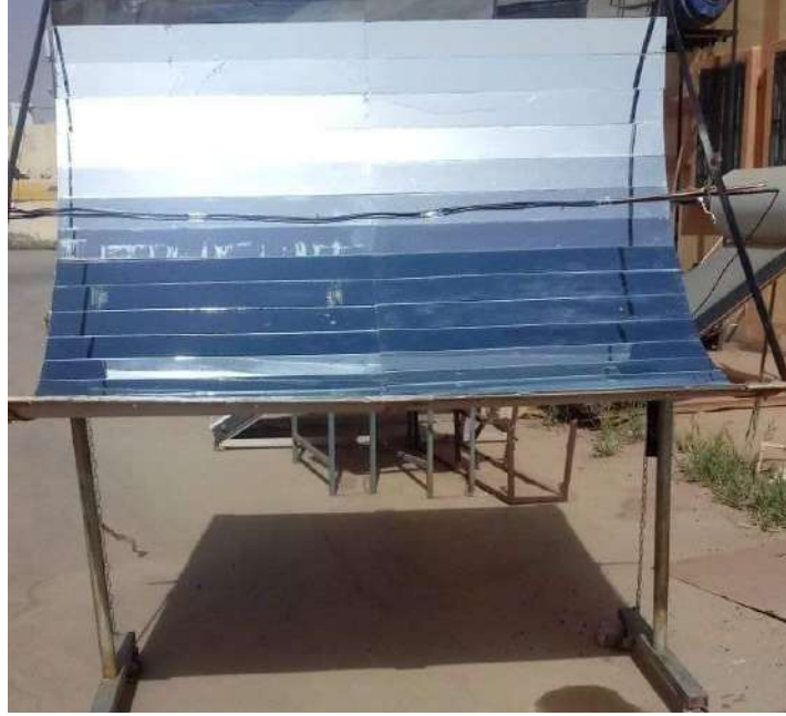
الشكل (5.4): صورة التركيب التجريبي للمركز (PTC2)
