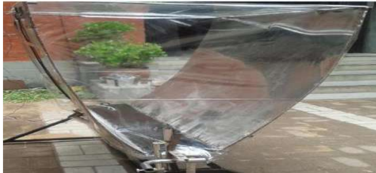
الشكل (13.1): المجمع الشمسي الاسطواني القطع مكافئ ذو العاكس المزدوج (CPC)
