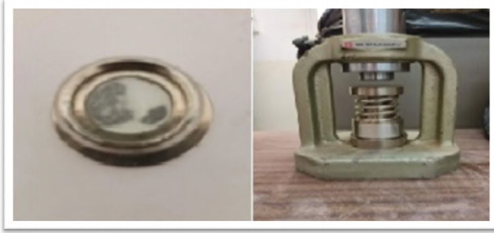
الصورة 21: صورة توضح عملية كبس الخليط و تحضير قرص KBr
