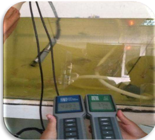
الشكل (V-39): يمثل صورة لجهاز قياس T و S و CE
