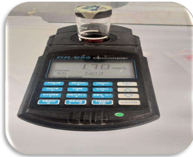
الشكل (43-V): يمثل صورة لجهاز قياس (Spectrophotomètre (DR/890)
