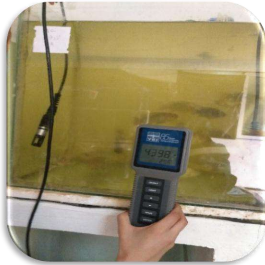
الشكل (40-V): يمثل صورة لجهاز قياس DO
