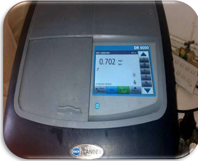
الشكل (42-V): يمثل صورة لجهاز قياس Spectrophotometère (DR/6000)
