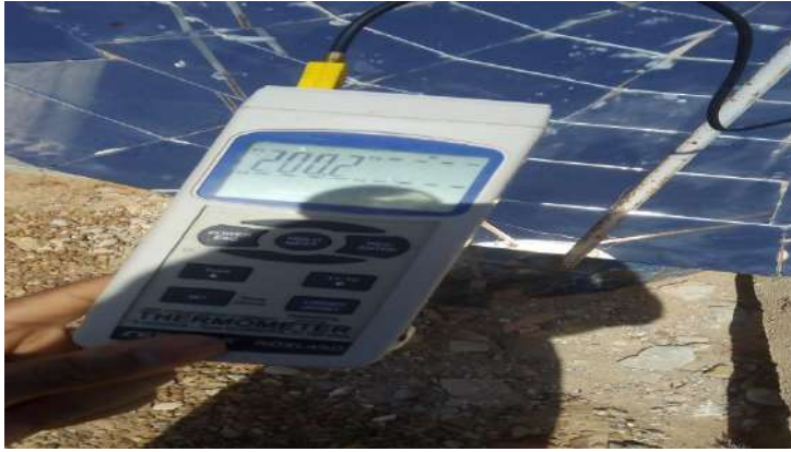
الشكل (4-6): المقياس الحراري من نوع (OMEGA RDXL4SD).
