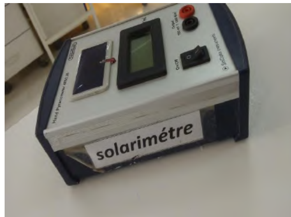
الشكل (4-10): جهاز الإشعاع الشمسي من نوع (Frederiksen4890.20).
