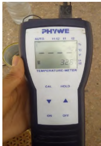
الشكل (4-7): المقياس الحراري من نوع (PHYWE-M*AN).
