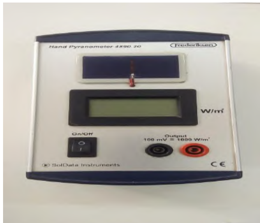
الشكل (4-10): جهاز الإشعاع الشمسي من نوع (Frederiksen4890.20).
