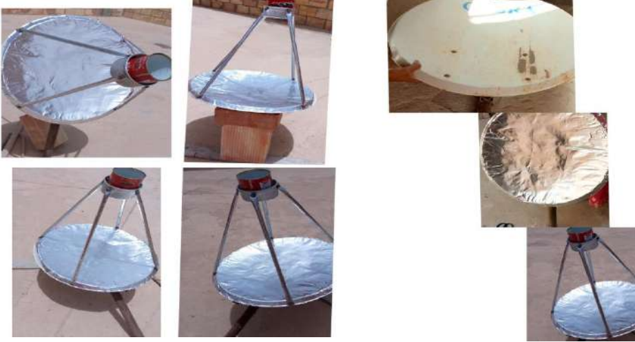
الشكل(4-15): نموذج مصغر للصحن الشمسي التقليدي.
