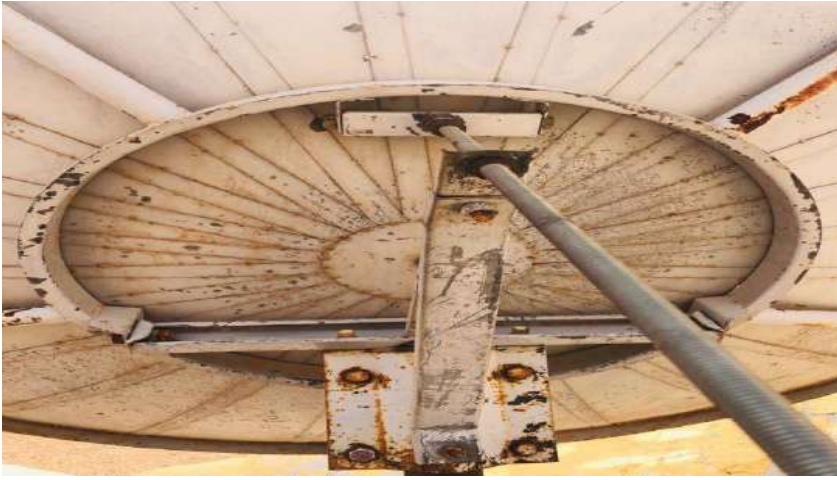
الشكل(4-4): صورة لنظام التتبع الذي يحتوي على أسطوانة ومحور دوران.
