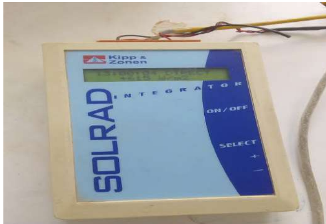
الشكل (4-9): جهاز قياس شدة الإشعاع الشمسي من نوع (kipp&zonen).
