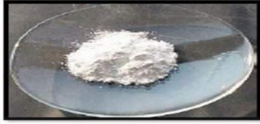
الشكل (6.I): أكسيد الزنك ( ZnO ) على شكل مسحوق. الشكل (7.I): بلورة أكسيد الزنك ( ZnO ) [30].
