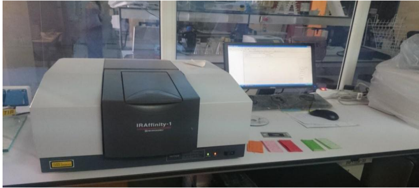
الشكل (II.12) : جهاز مطيافية الاشعة تحت الحمراء ولواحقه
