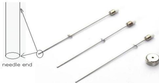
الشكل 69: صورة لنوع الإبرة الإسطوانية الخاصة لحاقن HPLC
