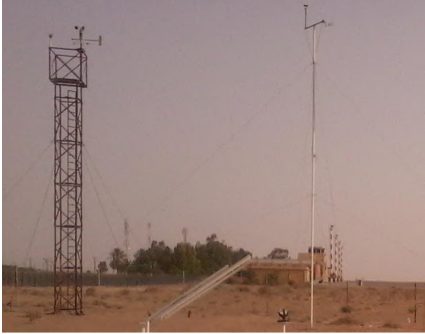
الشكل ( 6.III ):تثبيت الجهاز على اعمدة ارتفاعها 10متر
