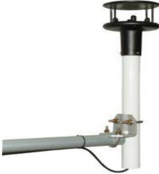
الشكل (1.III): صورة لجهاز الويندسونيك
