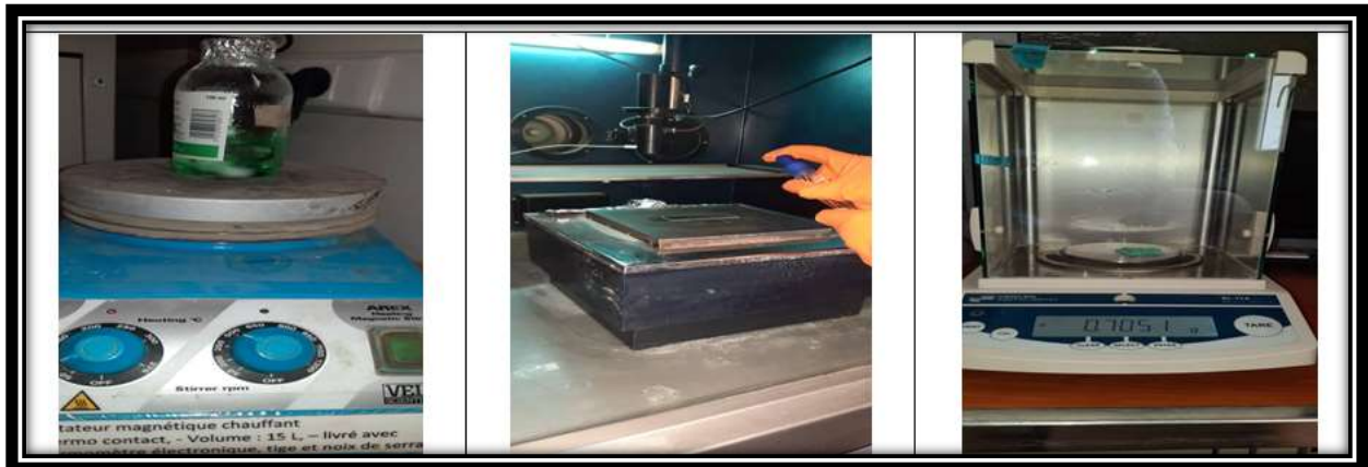
La figure III.1: rassemble des images des moyens utilisés pour déposer nos films : le mélangeur magnétique , le dispositif de thermolyse , la balance.
