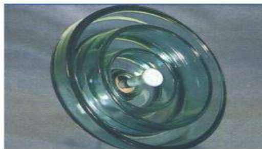
Figure I.11 : Isolateur à capot et tige de profil anti-brouillard (forme A)
