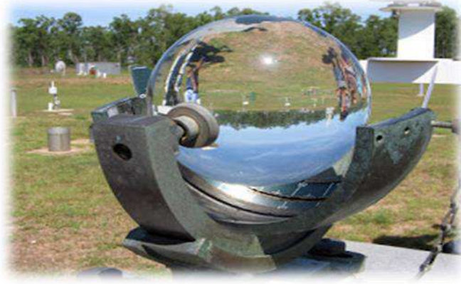
الشكل(II-7): صورة لجهاز كامبل ستوكس لقياس طول فترة سطوع الشمس [21].
