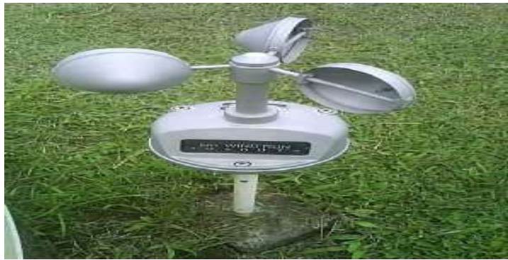
الشكل (8-1) :جهاز قياس سرعة الرياح [4].
