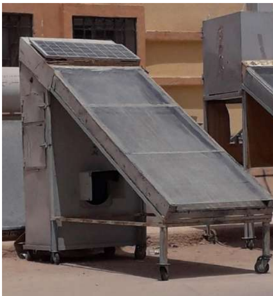
Figure IV.1 : Séchoir solaire indirect à convection forcée.
