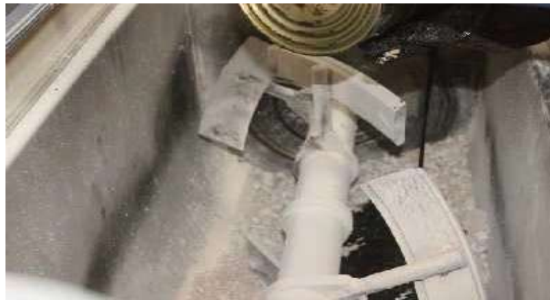
Figure V.2. Malaxage des granulats avec un bitume pur
