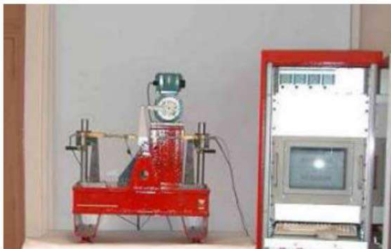
Figure I.22. Essai de fatigue en flexion 2 points sur éprouvettes trapézoïdales
