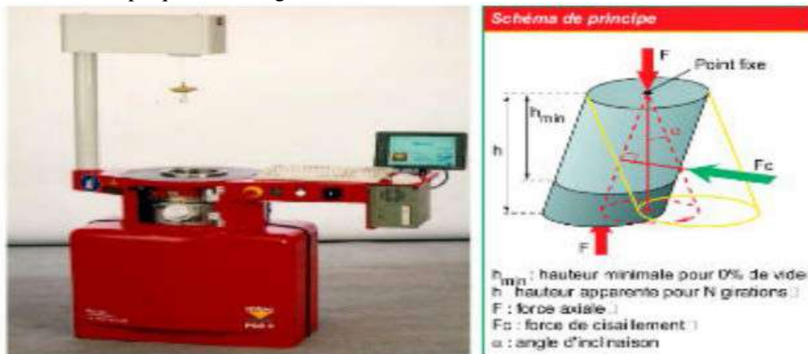
Figure I.16 Presse à cisaillement giratoire (PCG)
