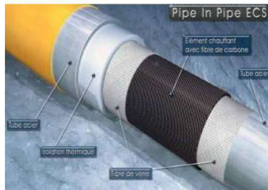
Figure 20: traitement thermique par Pipe in Pipe (PiP)
