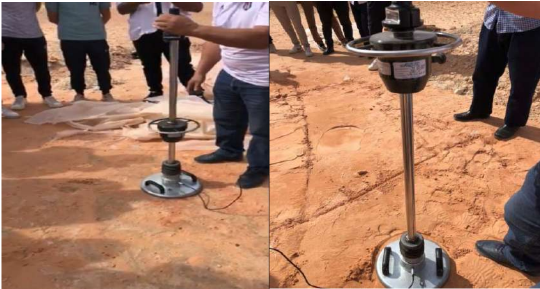
الصورة 18: القيام باختبار ضغط اللوحة الديناميكي على العينات
