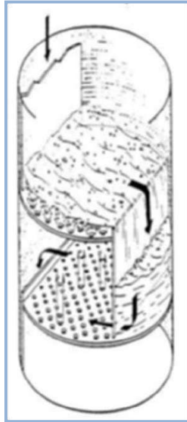
Figure II. 6 .L'écoulement dans une colonne à plateaux
