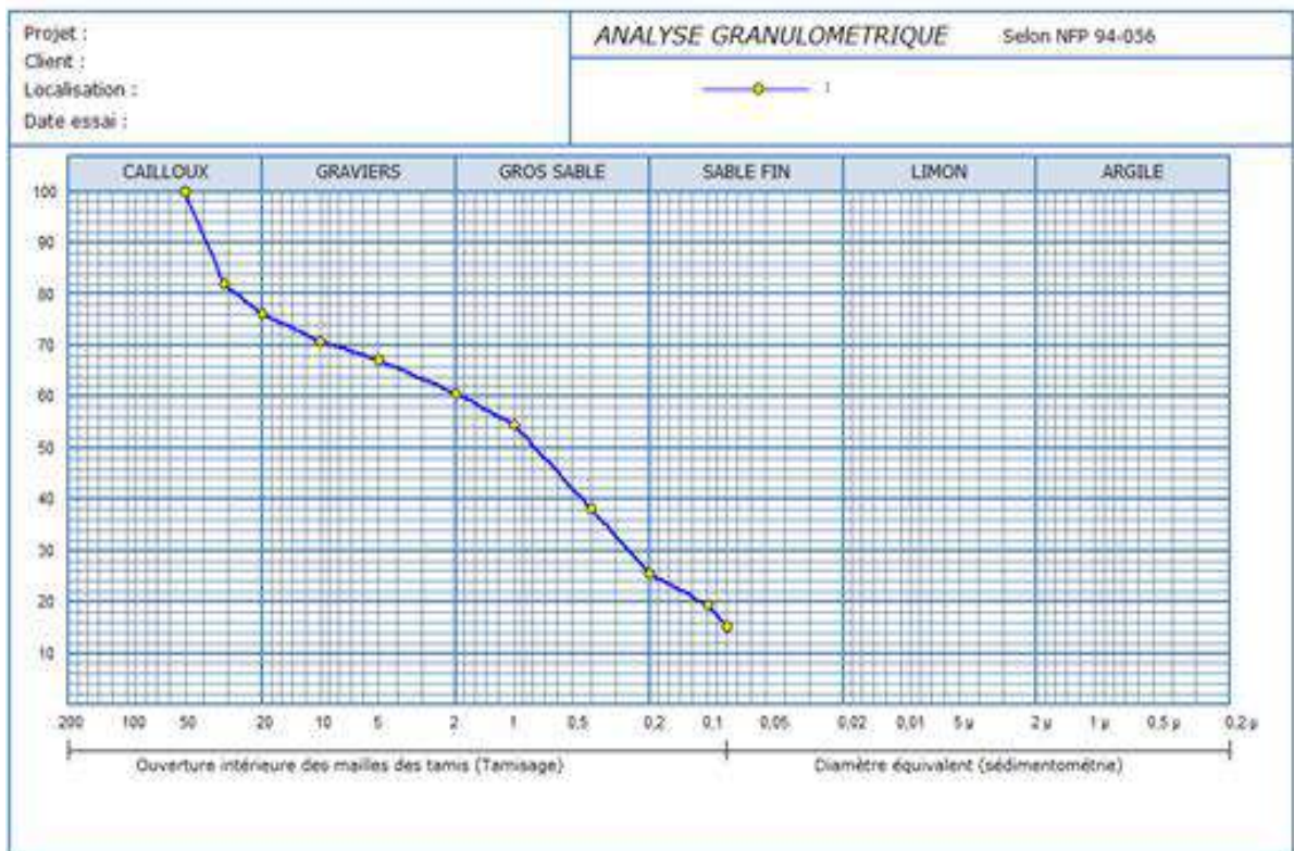
Figure I.2- Courbe de l'analyse granulométrique de tuf
