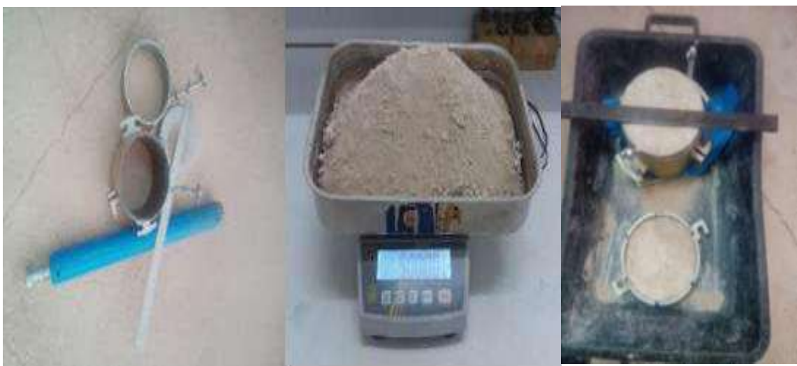
Figure III.2-Matériel nécessaire de Proctor Modifié
