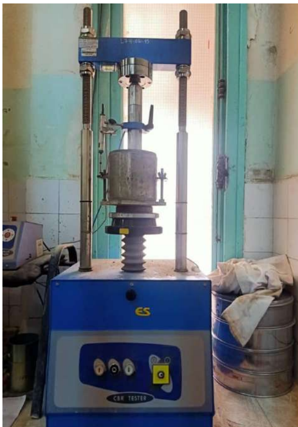
Figure III.5- Presse CBR avec acquisition de données
