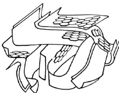
Figure (II.1): Représentation de la microstructure d'un charbon actif (Chaouch, N (2014))
