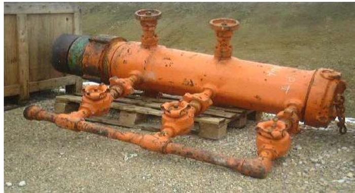
**Fig (8) : Photographie d'une tête de cimentation (cementing head).**
