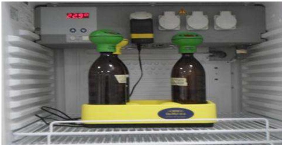
صورة رقم (13): قياس DBO<sub>5</sub> ( بالطاهر ، بن طبال 2021 )
