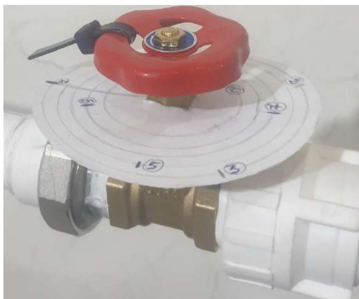
La figure III-5 : le disque qui définit les points de mesure des débits et les tours de fermeture
