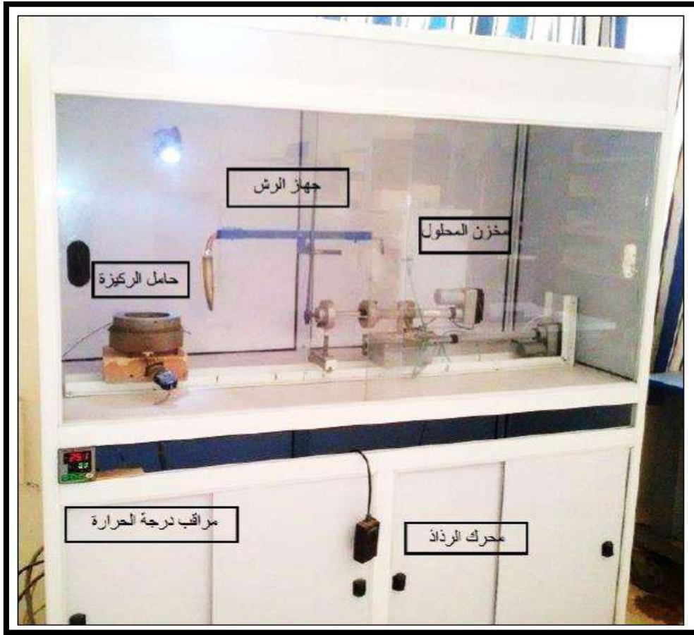
الشكل (III-1): التركيب التجريبي لترسيب الأغشية الرقيقة "تقنية الإنحلال الحراري".
