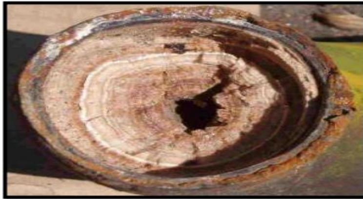
Figure I . 6 : Dépôt de carbonate de calcium [14]
