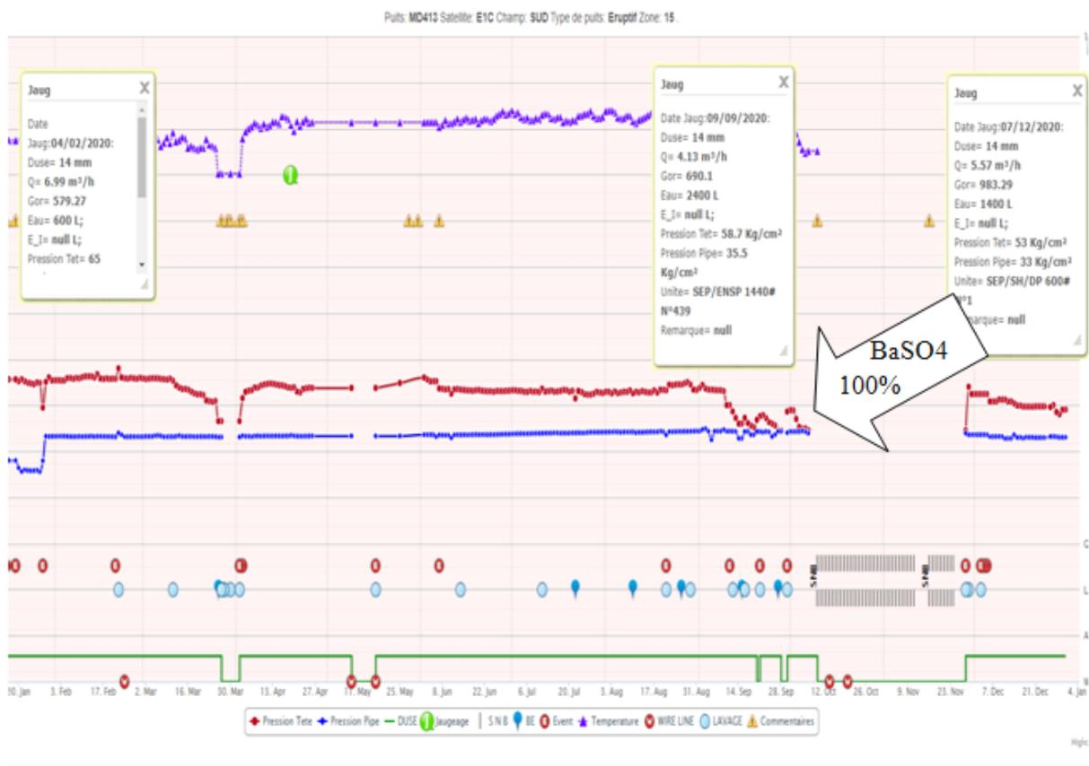
Figure IV . 10 : Cahier de courbes de puits MD413 – Après de l'utilisation de l'inhibiteur CHIMEC 1264 [26]
