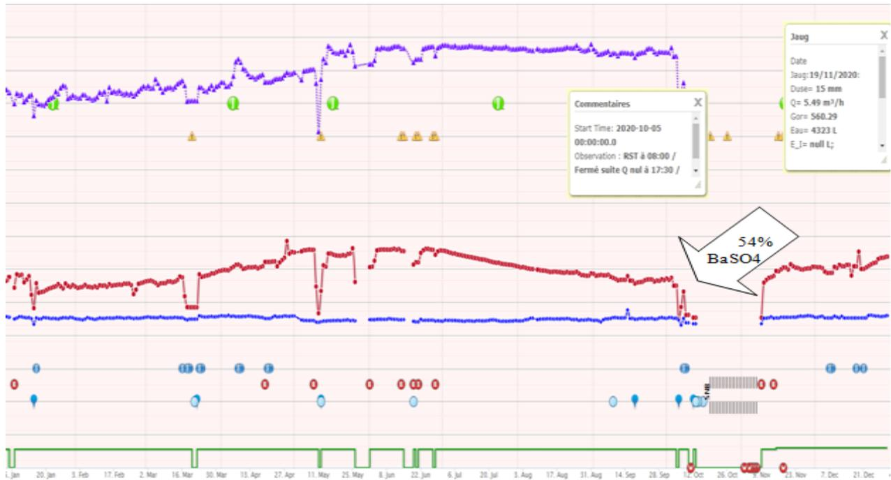
**Figure IV . 12 : Cahier de courbes de puits MD633 – Après de l'utilisation de l'inhibiteur CHIMEC 1264 [26]**
