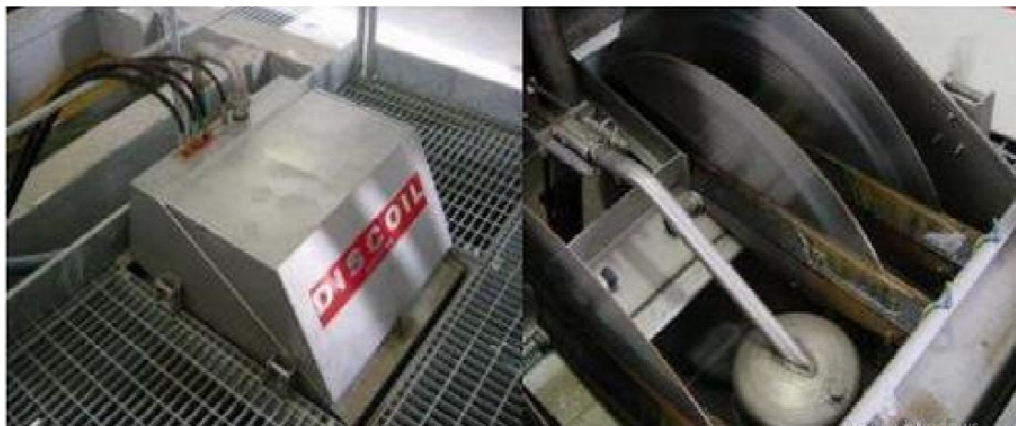
Figure I.3: Déshuileur flottant à disque rotatifs (discoil) [8]
