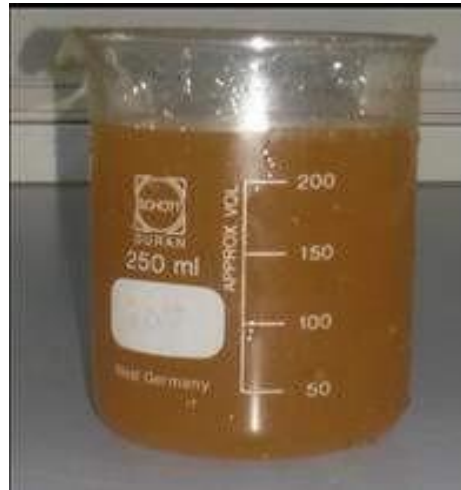
Figure II.19: Echantillon des eaux huileuses de sortie de Séparateur tri-phasique
