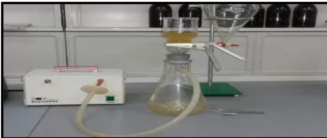
Figure II.21: Dispositif de filtration sous vide
