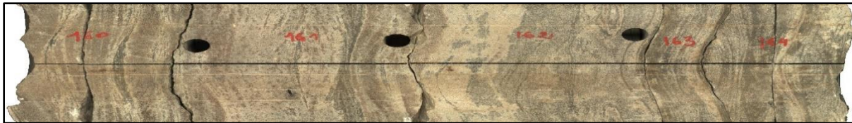
Figure 27 : carotte de puits de Quratzites de Hamra HGA-14 (Sonatrach DP.2002)
