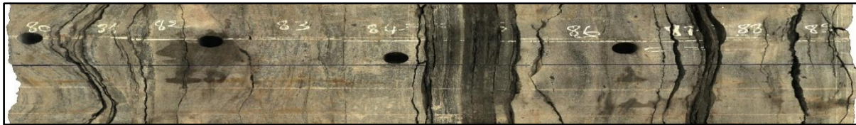
Figure 12 : carotte de puits de Quratzites de Hamra HGA-06 (Sonatrach DP.2002)
