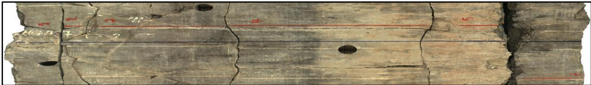
Figure 18 : carotte de puits de Quratzites de Hamra HGA-07 (Sonatrach DP.2002)
