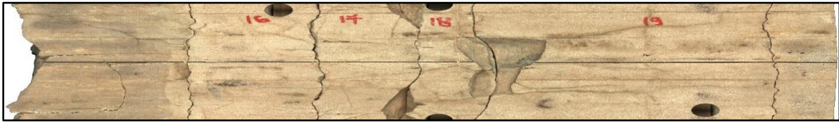
Figure 24 : carotte de puits de Quratzites de Hamra HGA-14 (Sonatrach DP.2002)
