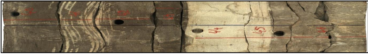
Figure 17 : carotte de puits de Quratzites de Hamra HGA-07 (Sonatrach DP.2002)
