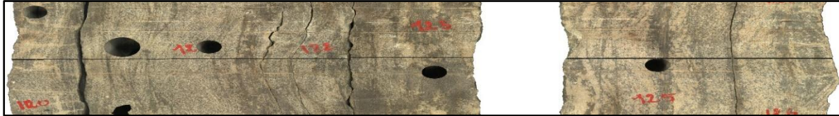
Figure 26 : carotte de puits de Quratzites de Hamra HGA-14 (Sonatrach DP.2002)
