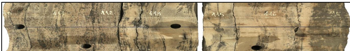
Figure 13 : carotte de puits de Quratzites de Hamra HGA-06 (Sonatrach DP.2002)
