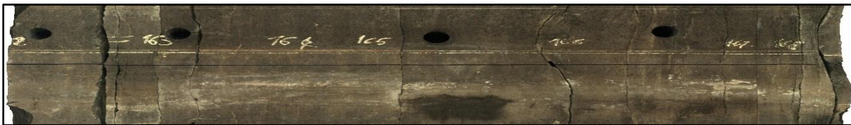
Figure 14 : carotte de puits de Quratzites de Hamra HGA-06 (Sonatrach DP.2002)
