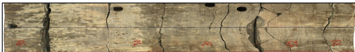
Figure 16 : carotte de puits de Quratzites de Hamra HGA-07 (Sonatrach DP.2002)
