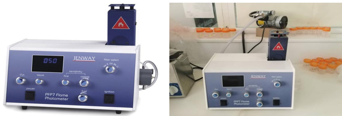
Fig. IV. 6 spectrophotomètres à émission de flamme type JENWAY PFP7.
