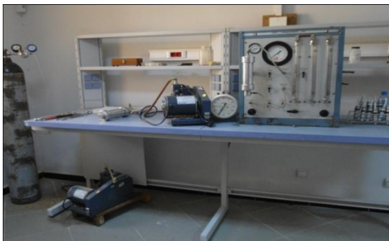
Figure 18. Perméamètre conventionnel (gauche) ; Confining Measurement System - CMS 300 – (droite)[24].
