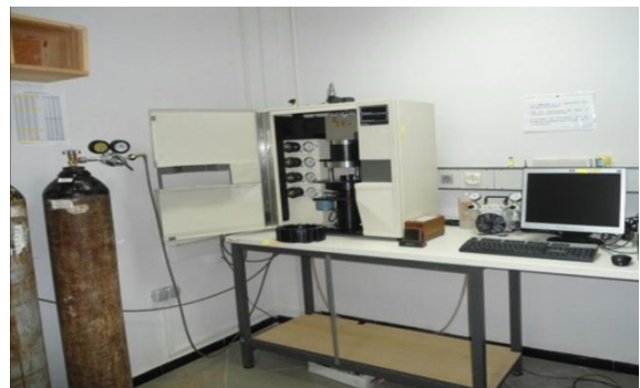
Figure 18. Perméamètre conventionnel (gauche) ; Confining Measurement System - CMS 300 – (droite)[24].
