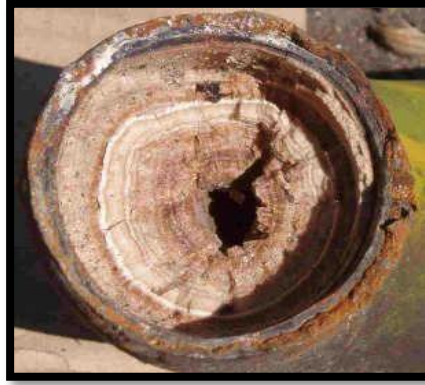
Fig5: Dépôt de sel contient le \text{CaCO}_3
