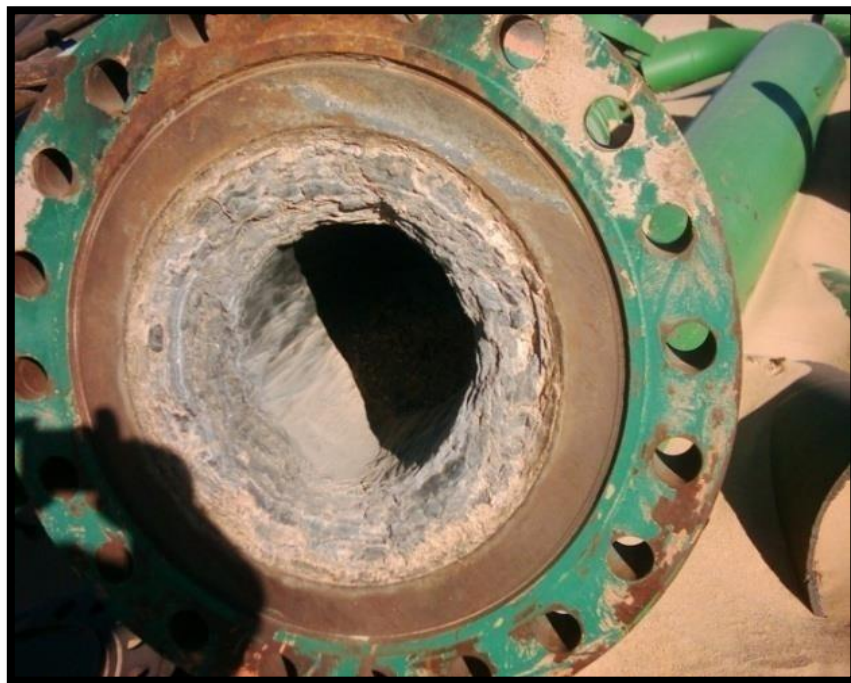
Fig8 : Dépôt de sel contient le \text{BaSO}_4
