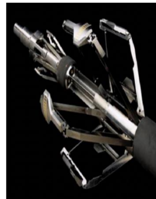
Fig II:3 : Photo de l'outil Earth Imager (Coure IAP)
