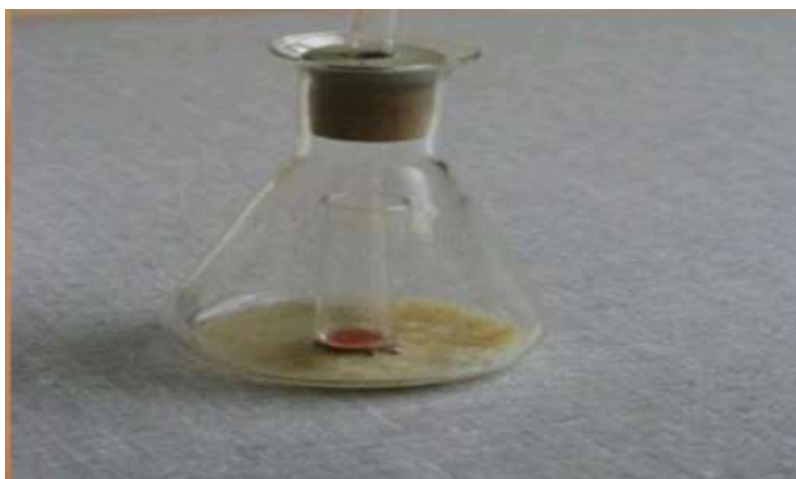
Fig.3.22: Mettre en contact l'acide et l'échantillon en reversant l'Erlenmeyer (ENSP-DML 2014)
