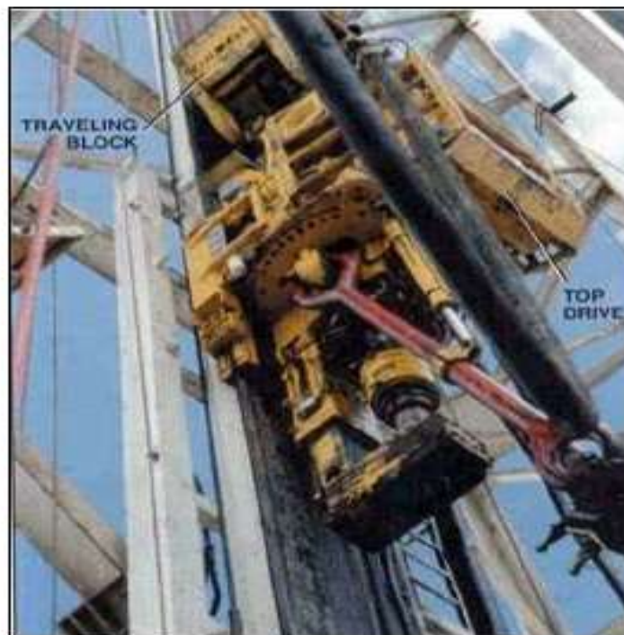
Fig2.10: Le top drive ( édité a DML)
