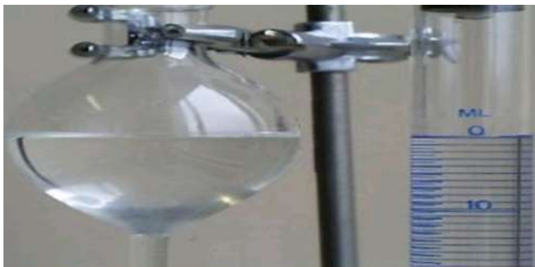
Fig.3.21: Fermer hermétiquement ce flacon à l'aide du bouchon raccordé au flexible du calcimètre(ENSP-DML 2014)
