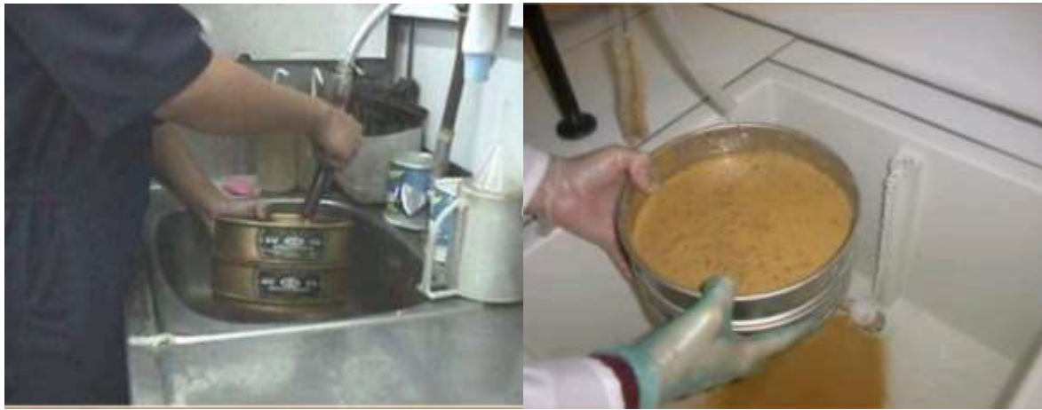
Fig.3.17: traitement des cuttings
