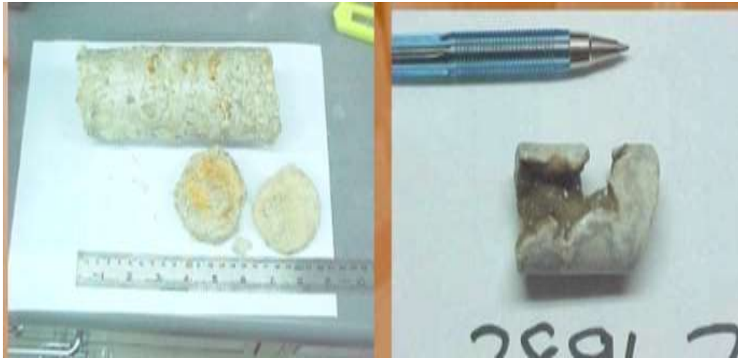
Fig.3.25: Orientation de l'échantillon à paraffiner en traçant (ENSP-DML 2014)
