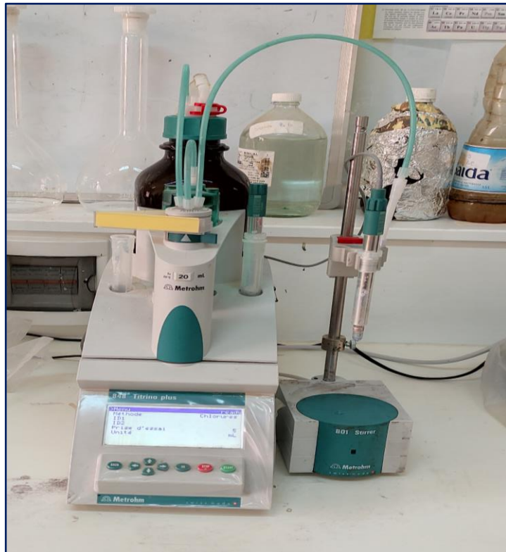
Fig. N°. V.1: Photo montrant L'appareil utilisé dans le dosage de chlorure
