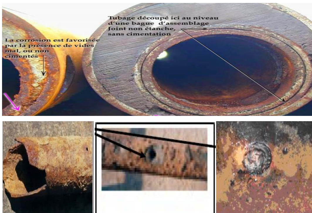
Figure III.6: L'évolution de la corrosion de concentrique tubage et tubing de puits injecteur d'eau MD435
