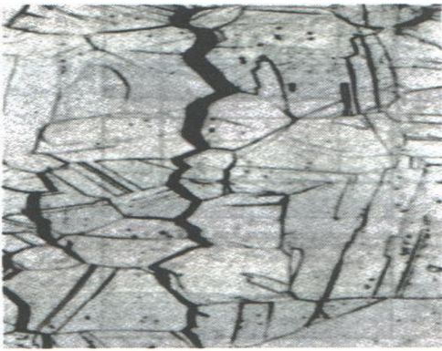
Fig. II.3 (a) Corrosion intergranulaire
