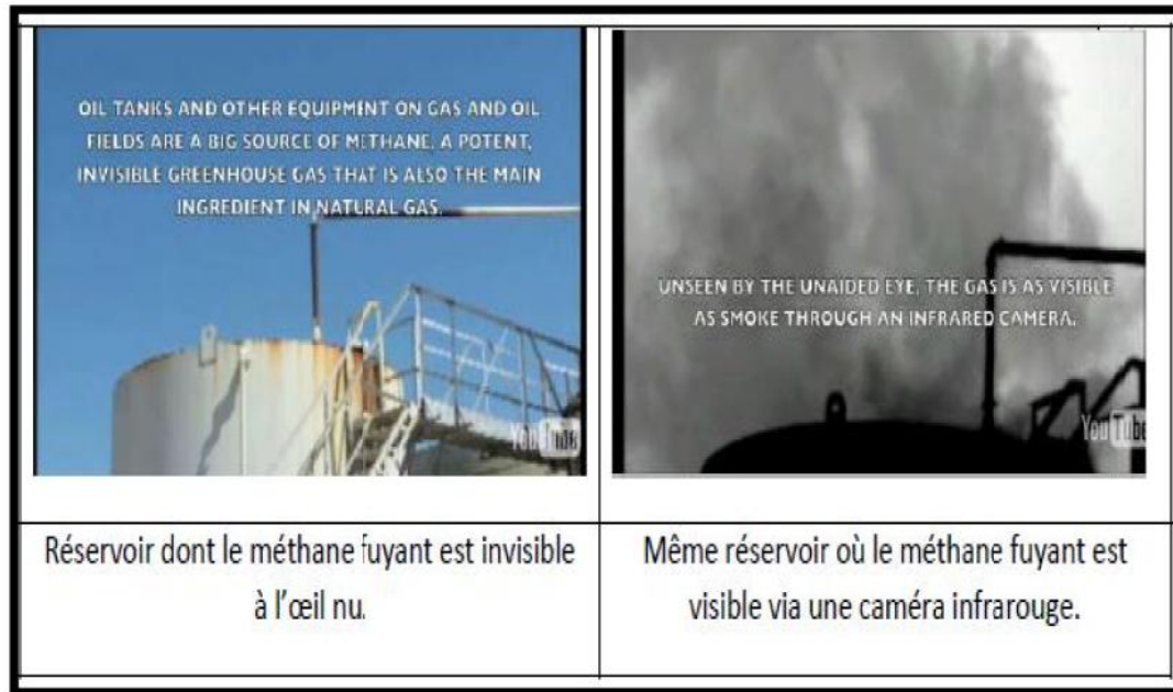
Figure II.4. La quantité de méthane fuyant les réservoir visible via une caméra infrarouge
