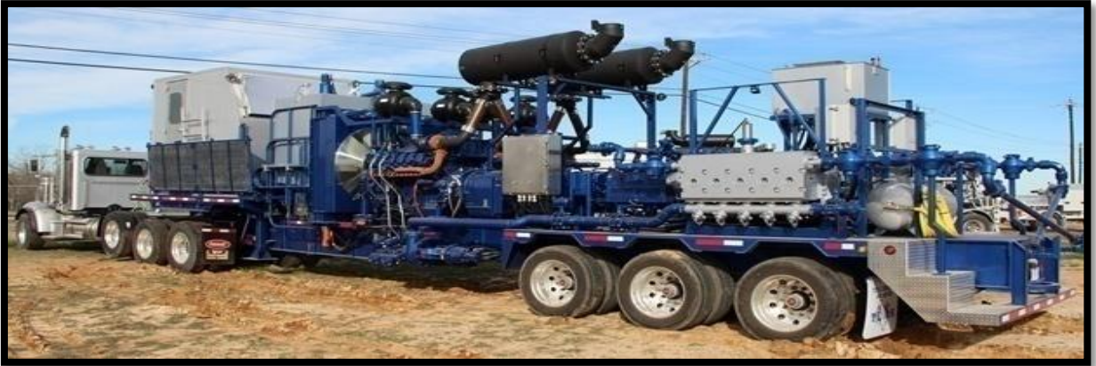
Fig. III.8: unité de pompage à haute pression
