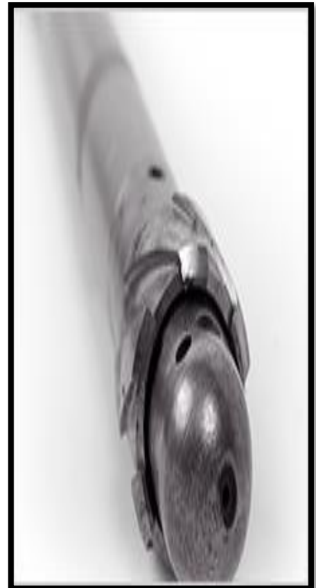
Fig. III.7 : Outil jet blaster
