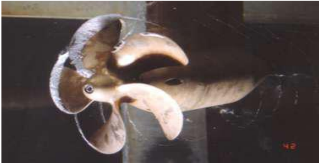
Figure 12 (II.10) : cavitation à lames sur une pale d'hélice
