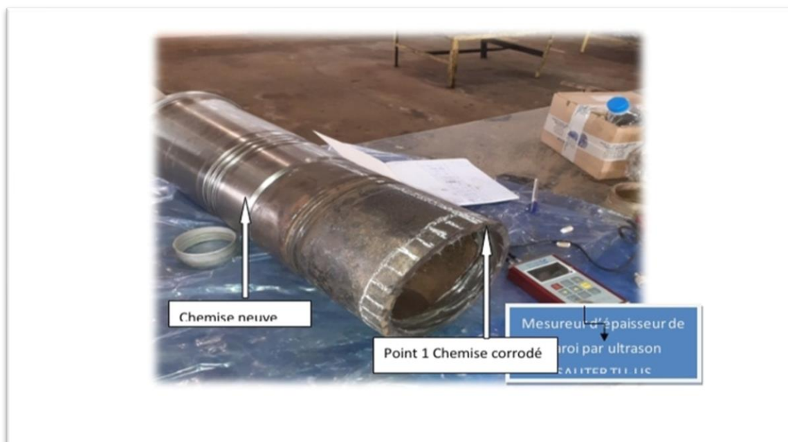
Figure 27 (IV 5) mesure d'épaisseur de la chemise
