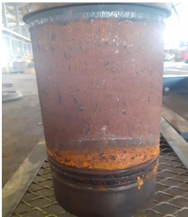
Figure 19 (III.5). La rouille sur la chemise
