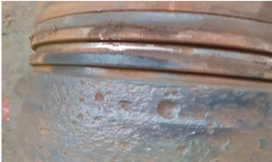
Figure 21 (III.7). Piquage et érosion d'une chemise par cavitation.
