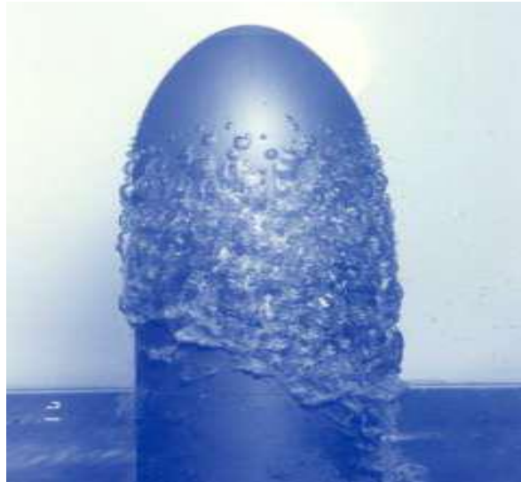
Figure 9 (II.7): Cavitation à poches sur un engin sous-marin
