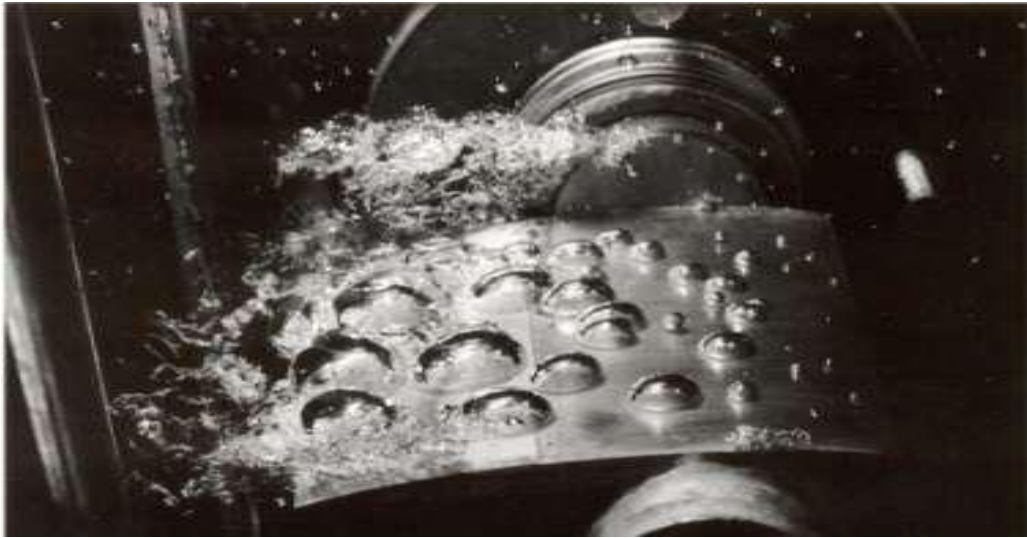
Figure 8 (II.6): cavitation à bulles sur un profil d'aile
