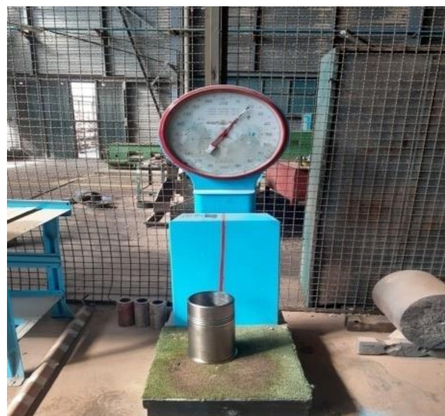
Figure 24 (IV.2). La masse chemise neuve m = 18600 \text{ g}
