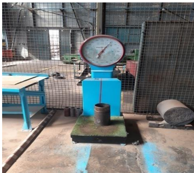
Figure 23 (IV.1) la masse de chemise corrodé m = 17800 \text{ g}
