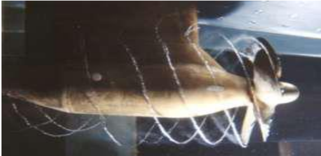
Figure 13 (II.11) : cavitation d'extrémité de pale d'hélice
