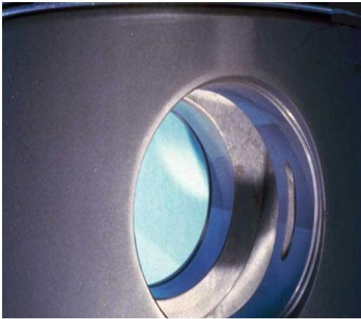
Figure I.17. Ouverture dans l'alésage d'axe de piston vers le passage d'huile vertical.
