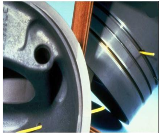
Figure I.18. Ouverture dans la rainure de segment de piston
