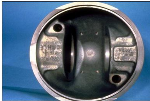
Figure I.16. Boîtier à chambre creuse (espace en forme de beignet)
