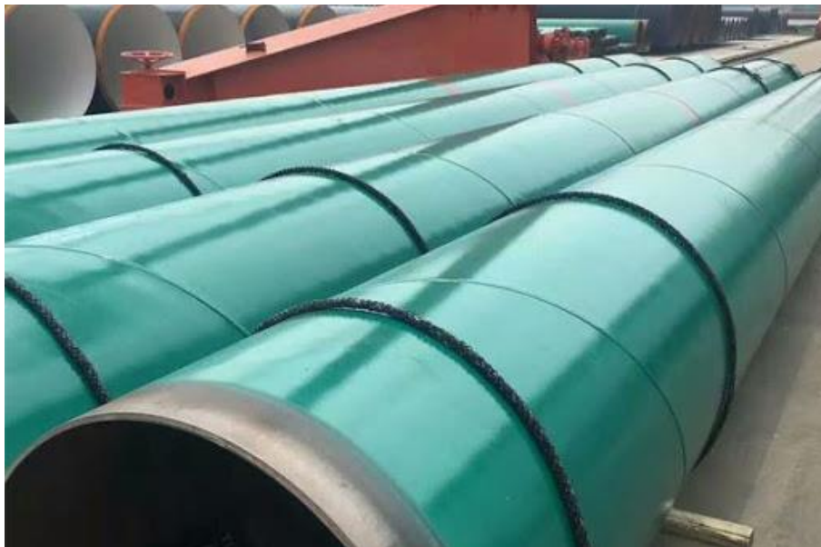
Figure II.13 Le Revêtement extérieur des pipelines [35]
