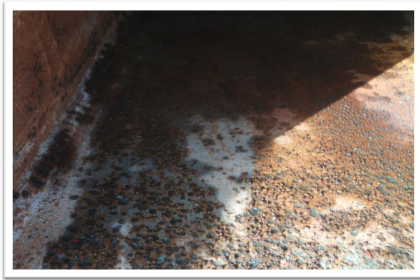
Figure I.1 : l'encrassement dans l'échangeur
