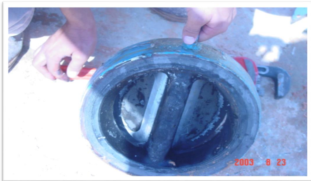
Figure III.2. Dépôt de sulfate de calcium sur un clapet de la colonne
