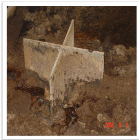
Figure I.2 : l'encrassement au fond de la colonne de distillation
