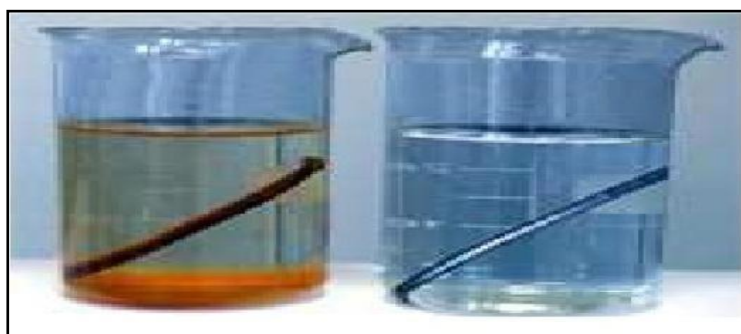
(a) sans inhibiteur de corrosion (b) avec inhibiteur de corrosion
