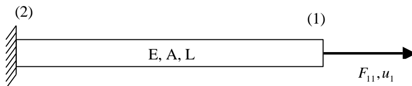
Fig. II.2 : Force F_1 appliquée à l'extrémité (1) . L'extrémité (2) est fixée
