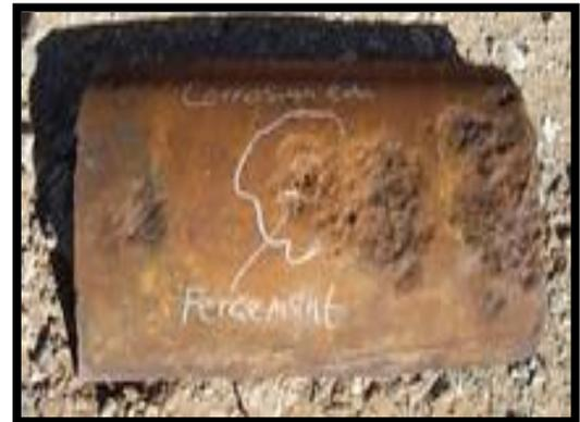
Figure II.3.2 : Percement d'une conduite enterrée (vue extene)
