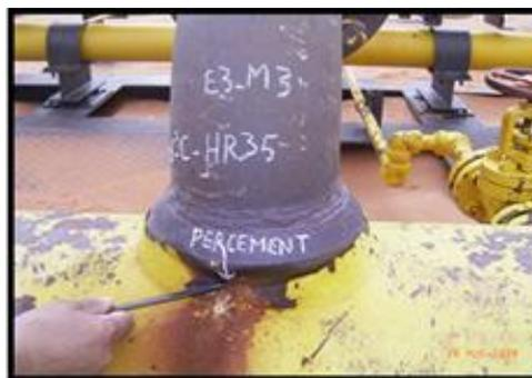
**Figure II.4** : *Le contrôle visuel des conduites corrodées*
