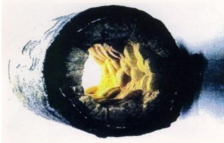
**Figure I.5 : Dépôt de sulfates** (15)
