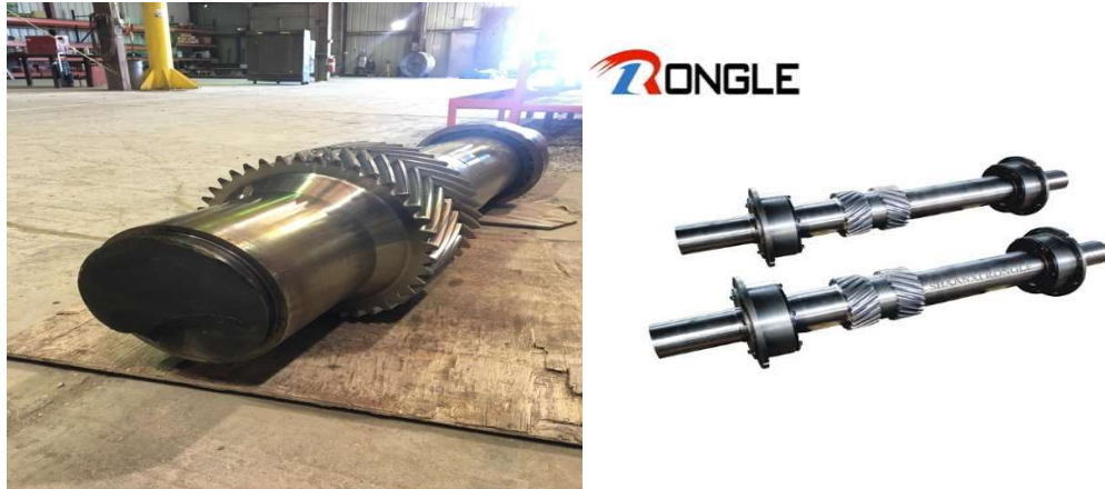
Figure II.9 : L'arbre grand vitesse (pinion shaft) [6]
