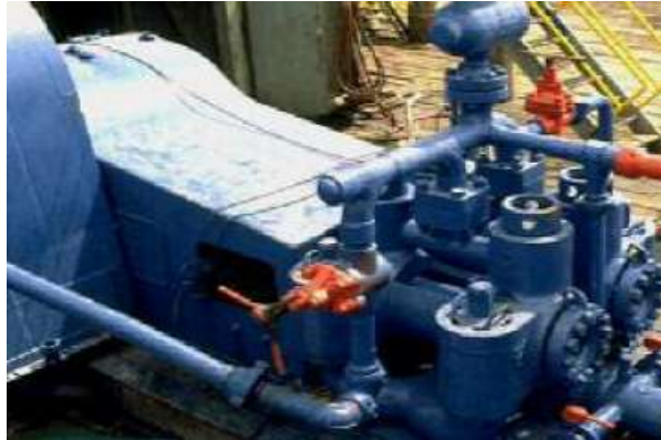
Figure II .1 : La Pompe à boue
