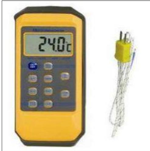
**Figure III.2:** appareil de Mesure de la température (thermocouples).
